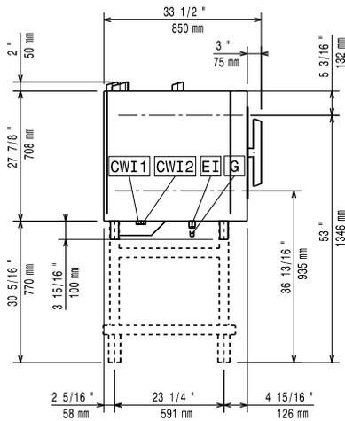
CWI1 = Entrada de agua fría 1 (limpieza)      EI = Conexión eléctrica (energía)
